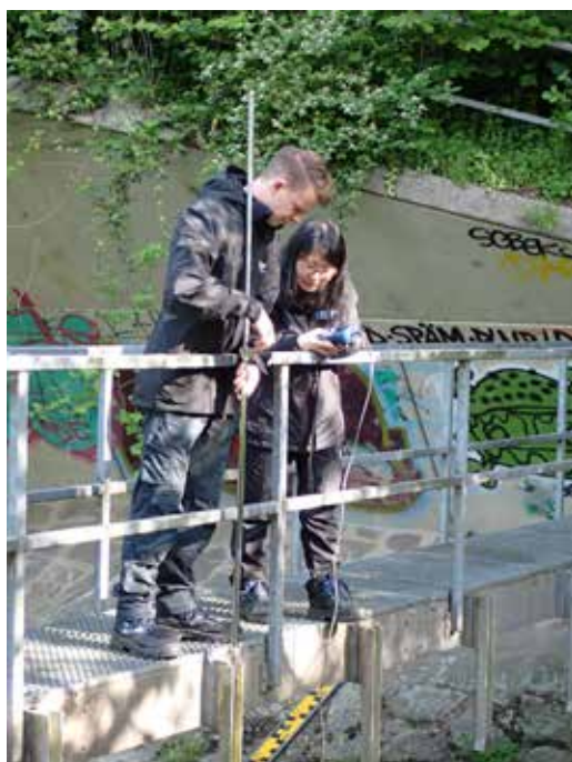
Messung der Fließgeschwindigkeit mit magnetisch-induktivem Strömungsmesser
